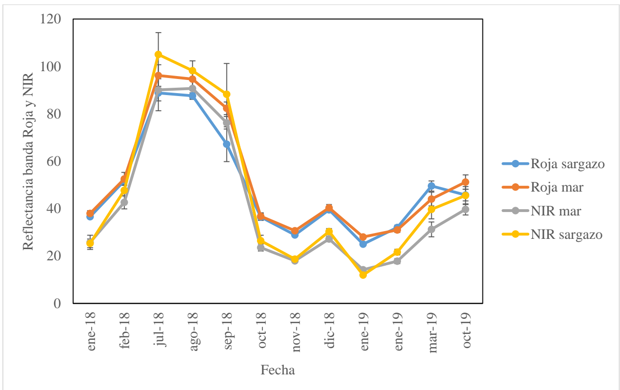
Figura 20. Respuesta espectral de las bandas roja e infrarroja de la clase sargazo y mar de la escena 019-047.
