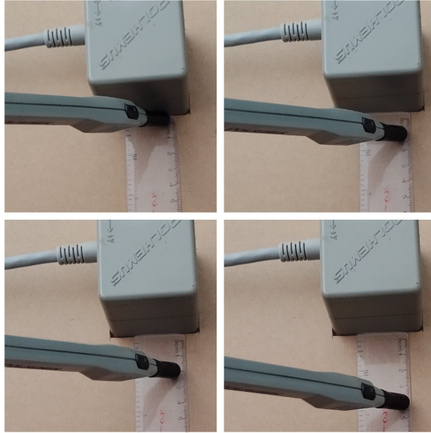
Figura 3.15: Obtención de medidas de prueba para conocer la precisión del sensor.
