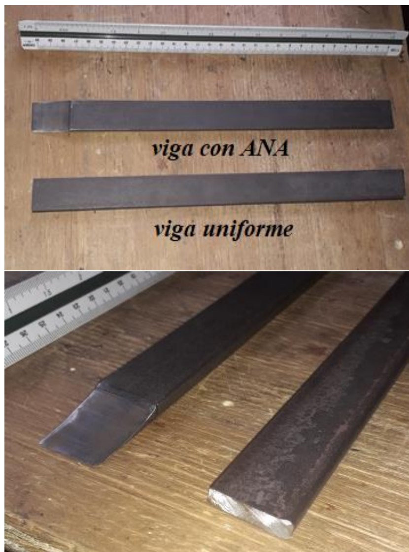
Fig. 35. Probetas de viga uniforme y con ANA.
