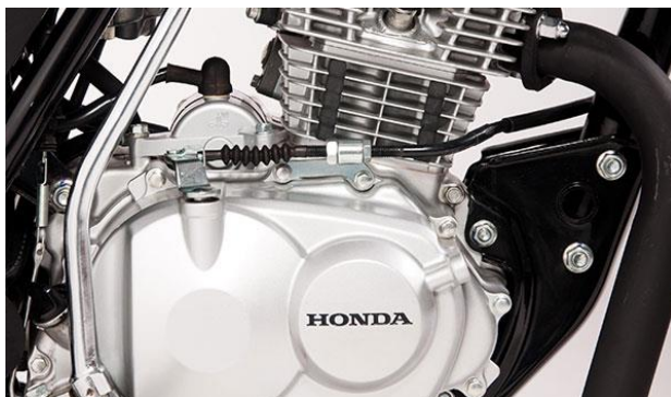
Fig. 48. Foto de un motor mono cilíndrico de motocicleta Honda cargo [22].
