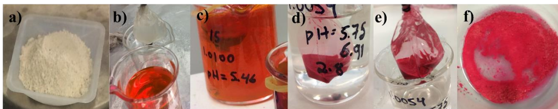
Figura 46. a) CLI inicial, b) sistema y solución de R6G, c) sistema en contacto con solución de R6G, d) adsorción durante 72 h, e) sistema extraído después de 72 h, f) CLI contaminado con R6G adsorbida en sitios activos.
