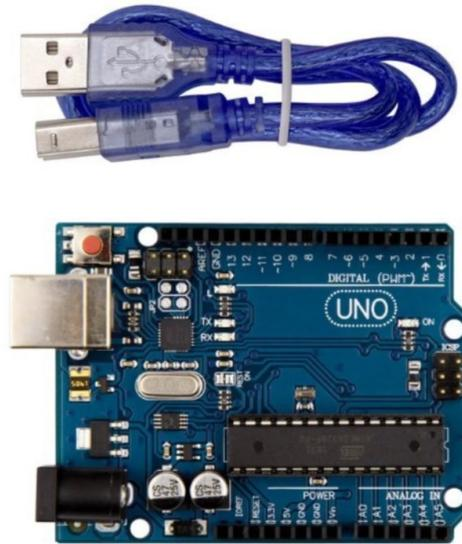
Fig. 12 KIT Arduino UNO R3 con cable USB para la transferencia de datos de los potenciómetros a la PC.
