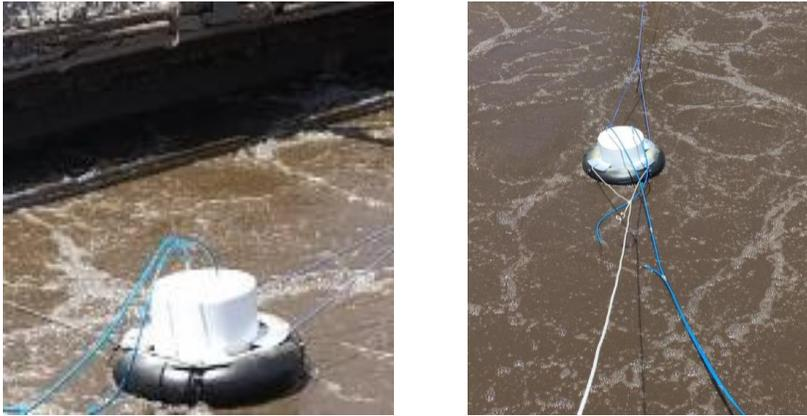
Figura 8. Cámara dinámica abierta B ( $CDA_B$ )
