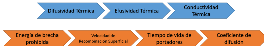
Figura 1.7: Recapitulación de las propiedades térmicas (azul), ópticas y de recombinación de portadores (naranja) que pueden estudiarse en semiconductores con técnicas fototérmicas.
