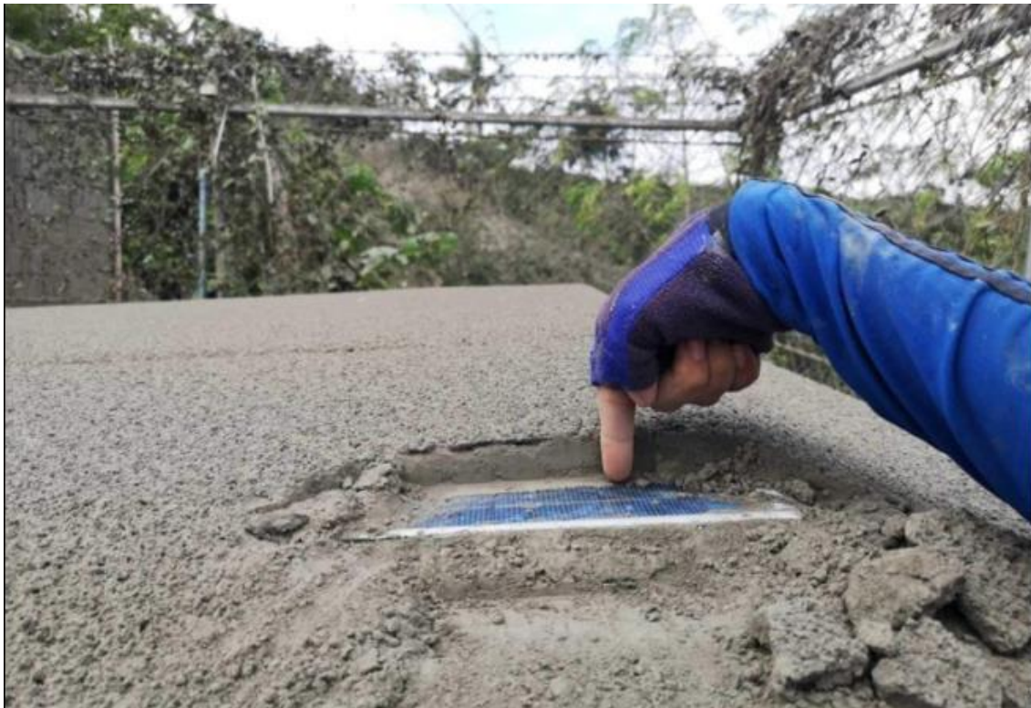
Figura 12. Módulos FV cubiertos de ceniza en Manila, Filipinas [24].
