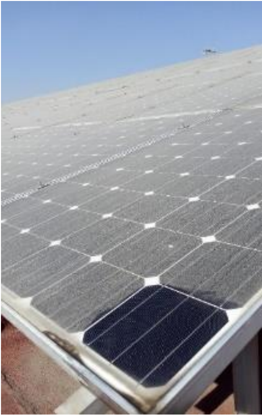
Figura 38. Soiling acumulado sobre los módulos del SFV del Cinvestav Zacatenco el día 9 de enero de 2020. Se limpió una celda para hacer notoria la capa de suciedad.
