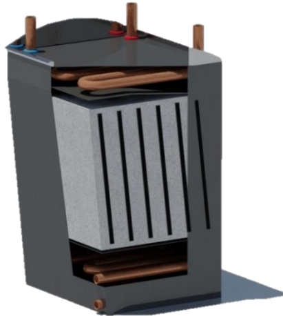
Figura 21.- Diseño del acumulador termoquímico en tres dimensiones. Fuente: Elaboración propia con el software AutoCAD.
