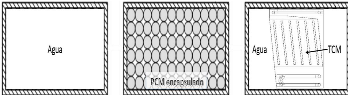
Figura 22.- Esquema de los tipos de acumuladores térmicos analizados y comparados. Fuente: Adaptación propia.
