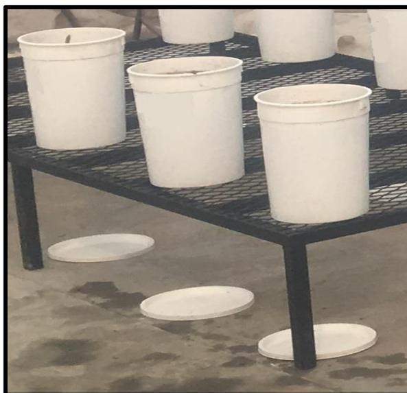
**Figura 7.** Macetas de 4 L con colectores de lixiviados para revisar la permanencia del material zeolítico en el suelo de campo.
