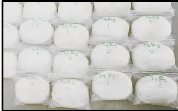
**Figura 12.** Esponjas de poliuretano, después de ser retiradas de las trampas de amoníaco, con solución de hidróxido de sodio.
