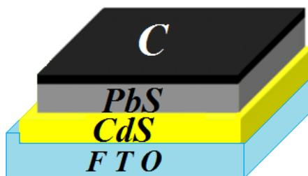
**Figura 14** Diagrama que representa la configuración de celda solar PbS/CdS.
