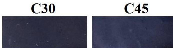
**Figura 37** Imágenes de las películas de PbS obtenidas con citrato de sodio como agente acomplejante; muestras C30 y C45 respectivamente.
