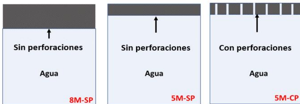
Figura 9: Dibujo esquemático de las configuraciones de carbón (A) 8M-SP (B) 5M-SP y (C) 5M-CP.
