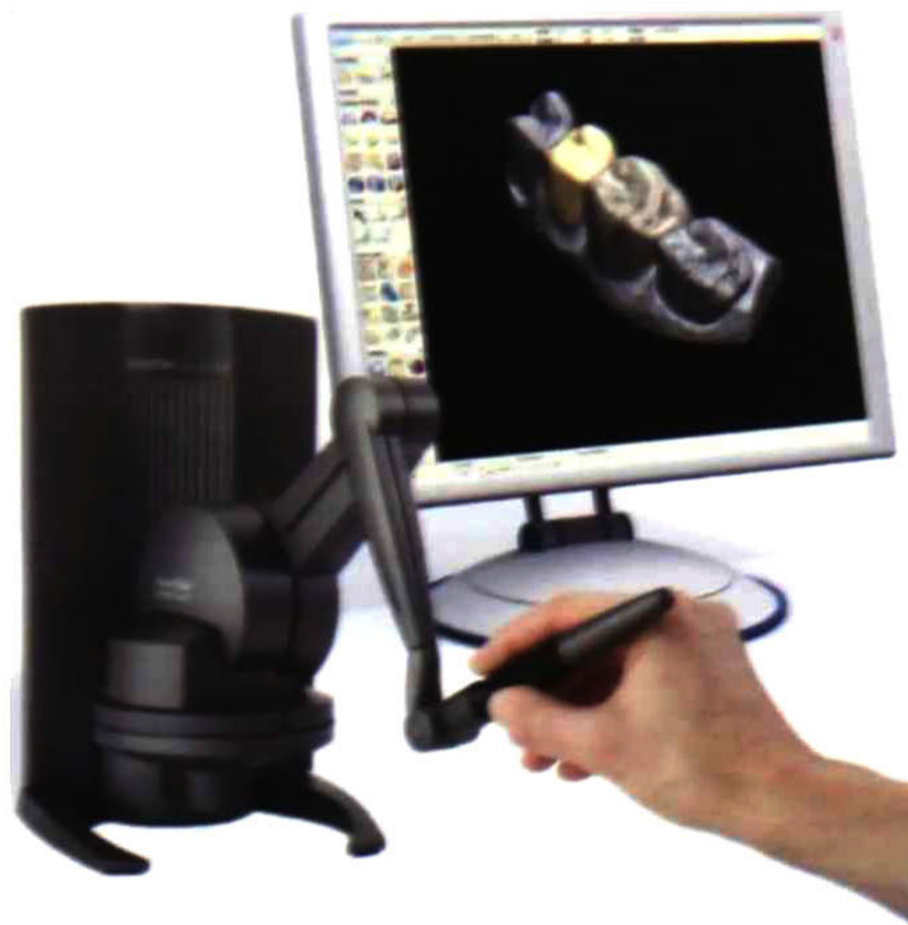
Figura 6. Interfaz háptica tipo joystick de 6 grados de libertad de SENSABLE Inc (1).
