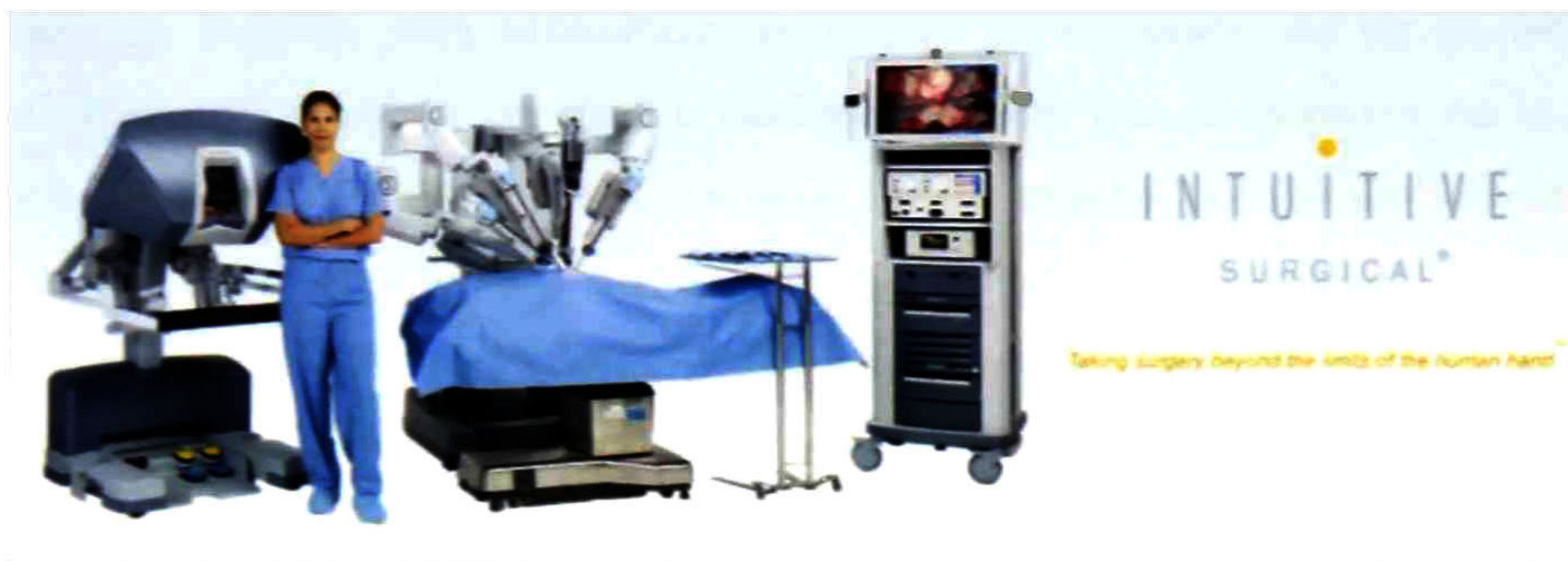
Figura 1. Sistema de Cirugía DaVinci desarrollado y comercializado por la empresa INTUITIVE SURGICAL, el cual consiste de una mesa quirúrgica unida a 4 brazos robot, una consola o interfaz de control y una pantalla.
