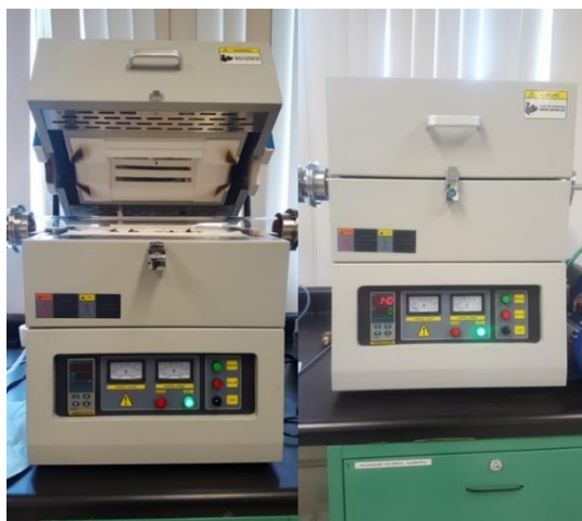
Figura 13. Etapa de carbonización de las NFP.
