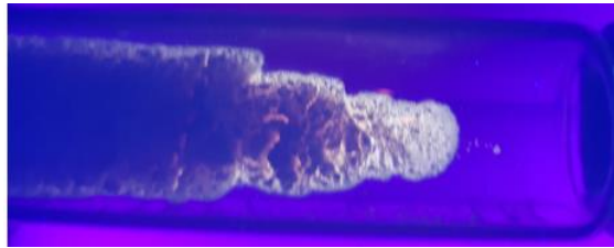
Figura 7.4.4.2 Muestra M20 iluminada con luz ultravioleta (365 nm).
