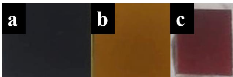
Figura 7-18: Imágenes tomadas a distintas temperaturas del sustrato de 10 V, 15 minutos de anodizado y 80 disparos de vanadio.
