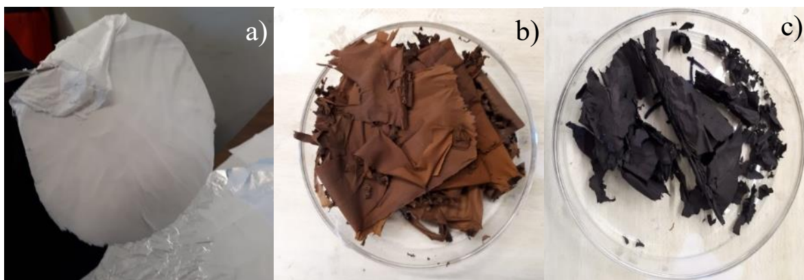
Figura 8. Etapas del proceso de obtención de NFC. a) NFC después de electrohilado, b) NFC estabilizadas a 250 °C y c) NFC carbonizadas.
