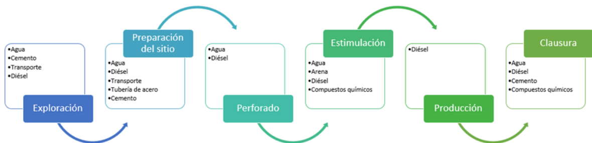
Figura 6. Esquema funcional del proceso de extracción del gas Shale.
