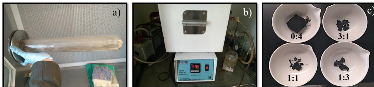
Figura 19. Tratamiento pirolítico: a) muestra M-GCGI-100 en reactor de cuarzo, b) horno tubular, c) biocarbones obtenidos.
