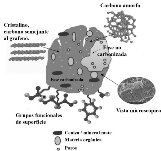
Figura 6 Representación de la estructura de un biocarbón [48].
