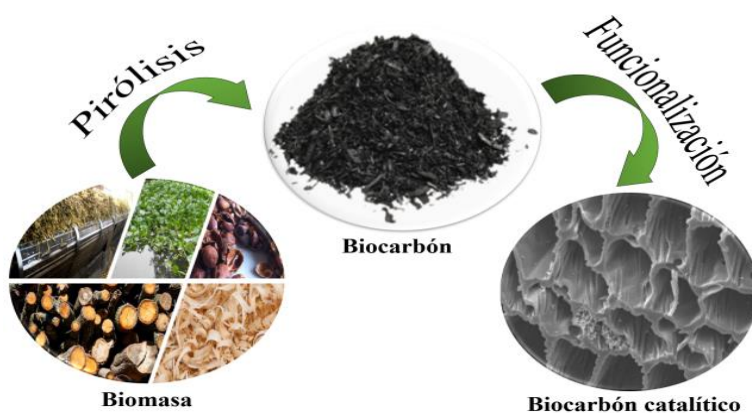
Figura 10 Proceso de obtención de biocatalizador.
