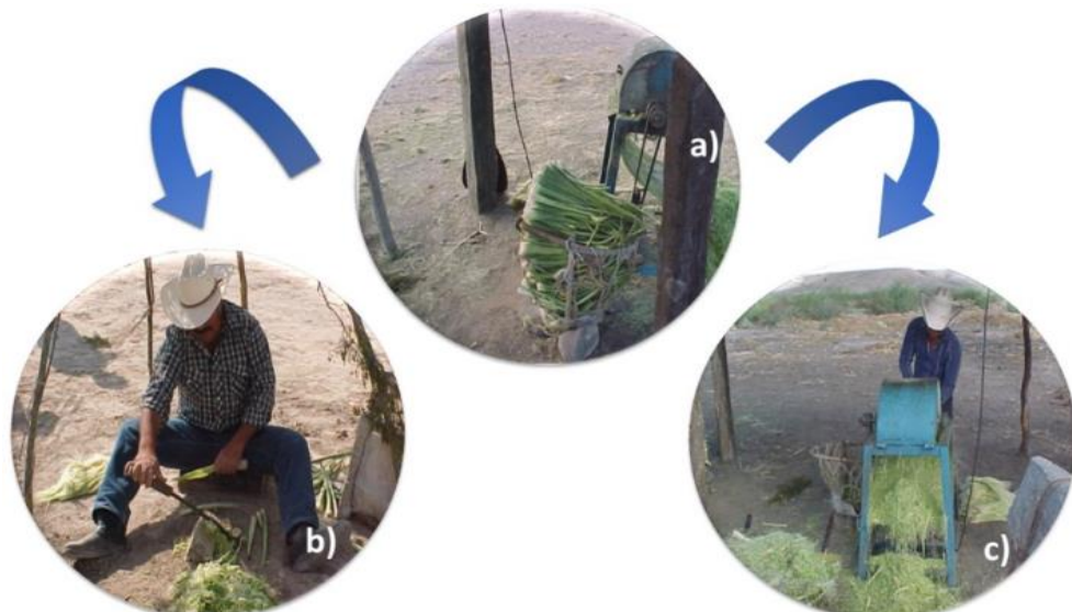
Figura 1. a) Hojas de lechuguilla, b) y c) Obtención de ixtle por vía manual y mecánica, respectivamente.
