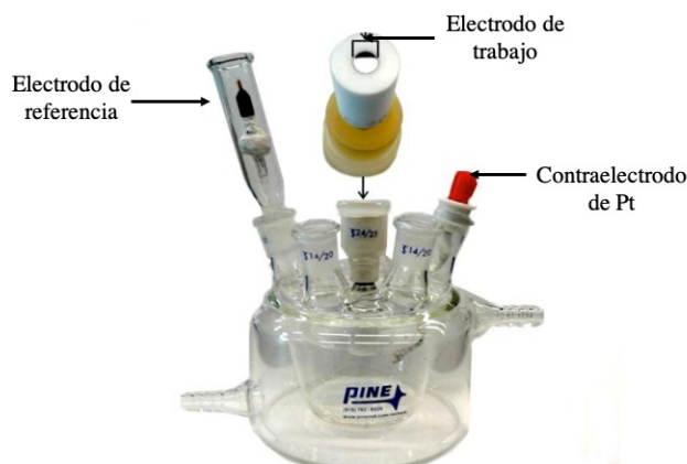
Fig. 4.2. Ilustración de un montaje de celda de tres electrodos.
