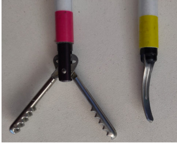
Fig. 4.7: Marcadores impresos de color rojo y amarillo colocados en la punta del instrumental.
