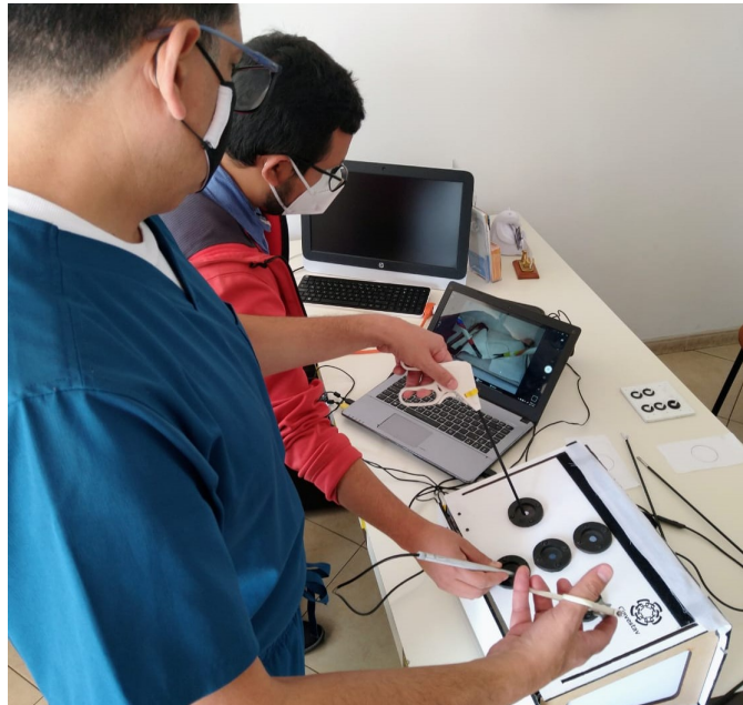
Fig. 5.16: Cirujano pediatra evaluando el funcionamiento del sistema mediante la tarea de corte.
