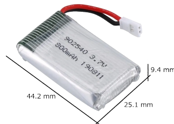
Fig. 2.9: Medidas aproximadas de la batería para el sistema de monitoreo.
