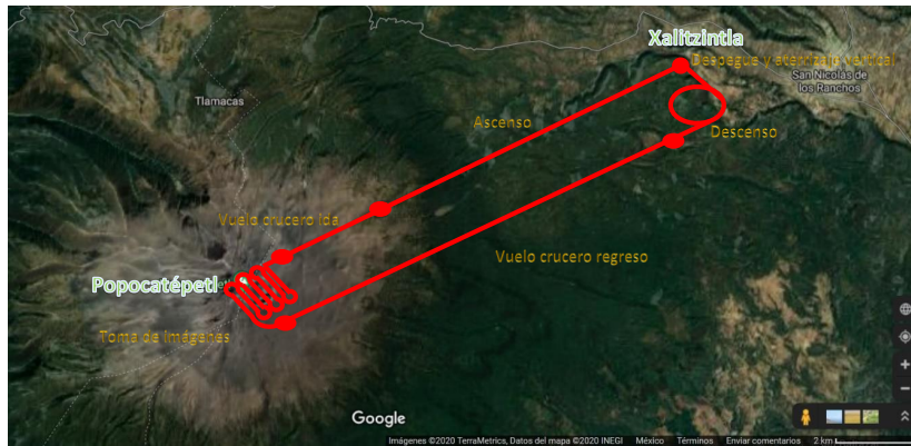
Figura 3.2: Trayectoria de la misión al cráter del volcán Popocatepetl, donde se despegan verticalmente de la población más cercana, se hace transición a vuelo horizontal. Después se toman fotografías del cráter, se regresa en vuelo crucero, para descender en espiral y hacer transición a vuelo vertical y aterrizar en el punto de despegue.
