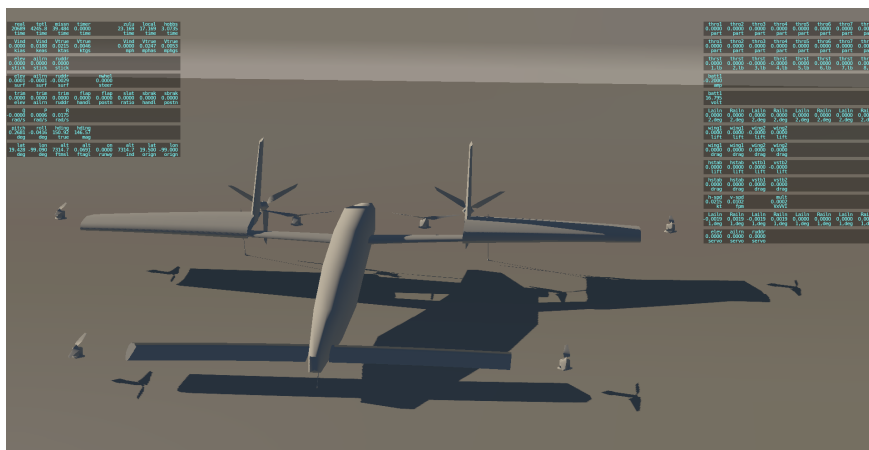
Figura 6.5: Modelo del vehículo en X-Plane desarrollado utilizando Plane Maker a partir del diseño preliminar.
