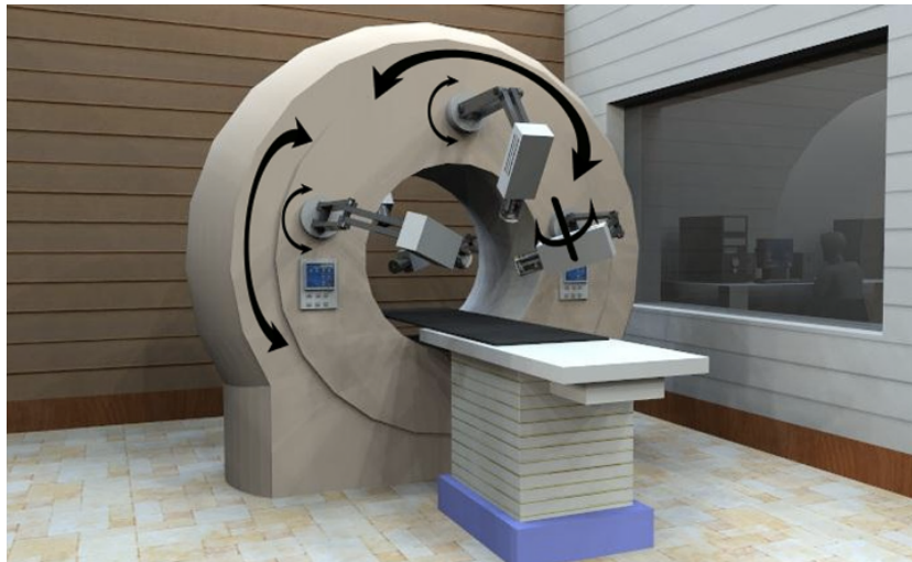
Figura 2.18: Prototipo de sistema de radioterapia guiada por imágenes modificado para ser implementado en tratamientos con RMAC [62]. El equipo combina un escáner CT convencional y varios tubos de rayos-X acoplados a brazos mecánicos encargados de generar haces de radiación con energía en el orden de kilovoltaje.
