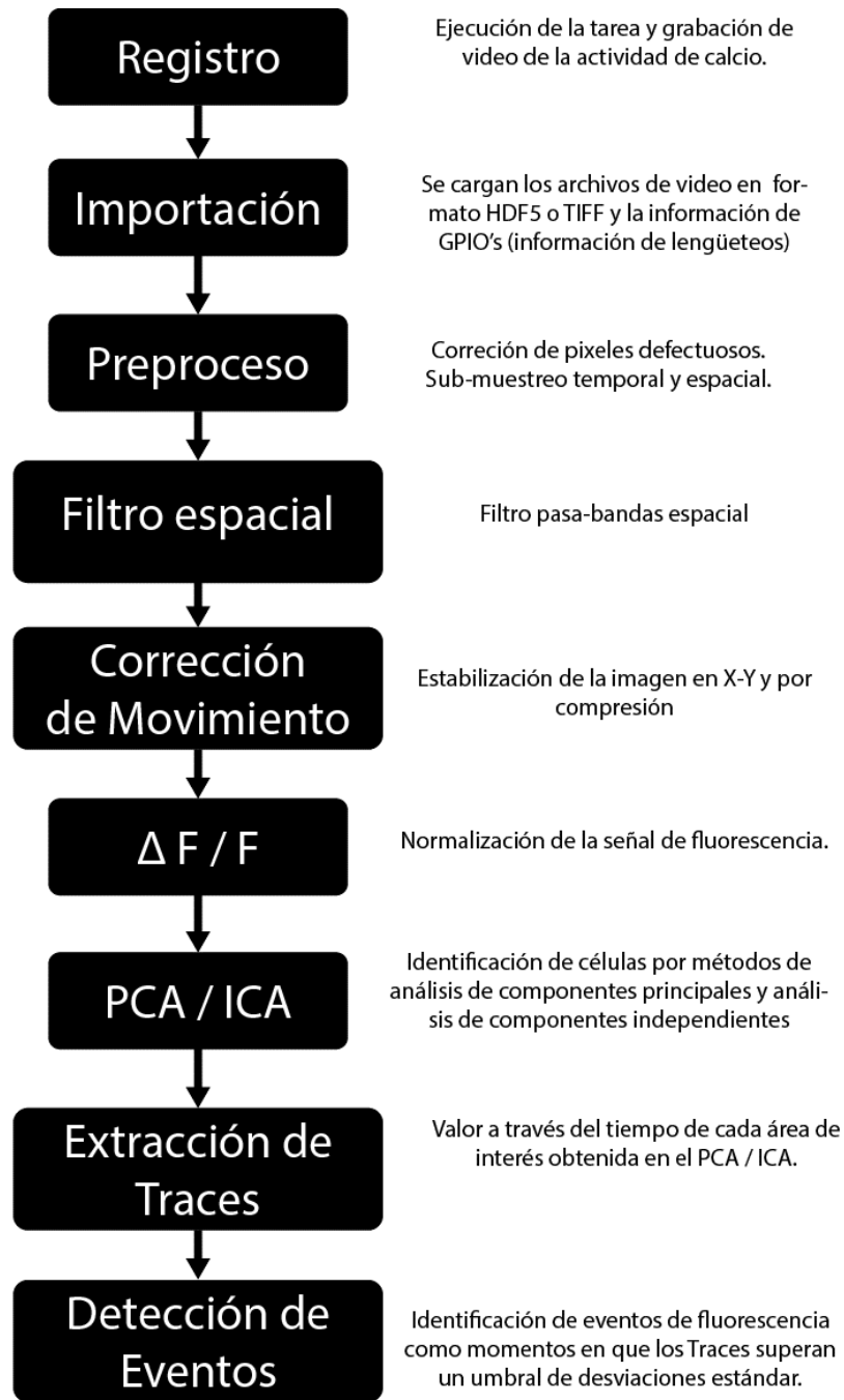
Diagrama de flujo del procesamiento de los videos de registro de microendoscopio.
