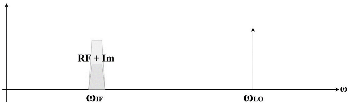
Fig. 1.5 Espectro antes y después del procesamiento en la etapa de frecuencia intermedia.
