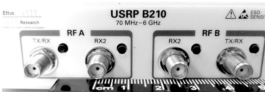
Fig. 4.37 Separación entre puertos de los receptores del USRP B210.
