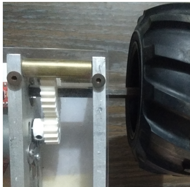
Figura 3.20: Implementación de la transmisión reductora en el robot.
