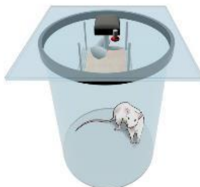
Figura 3. Ecuación para gases ideales en sistemas estáticos y representación de las cámaras de exposición a tolueno, con tapa provista de un puerto de inyección, una rejilla para colocar el papel filtro y un ventilador interno.
