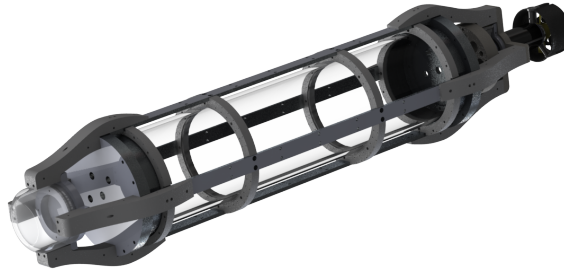
Figura 2.2: Estructura externa del vehículo Bentos versión 1.
