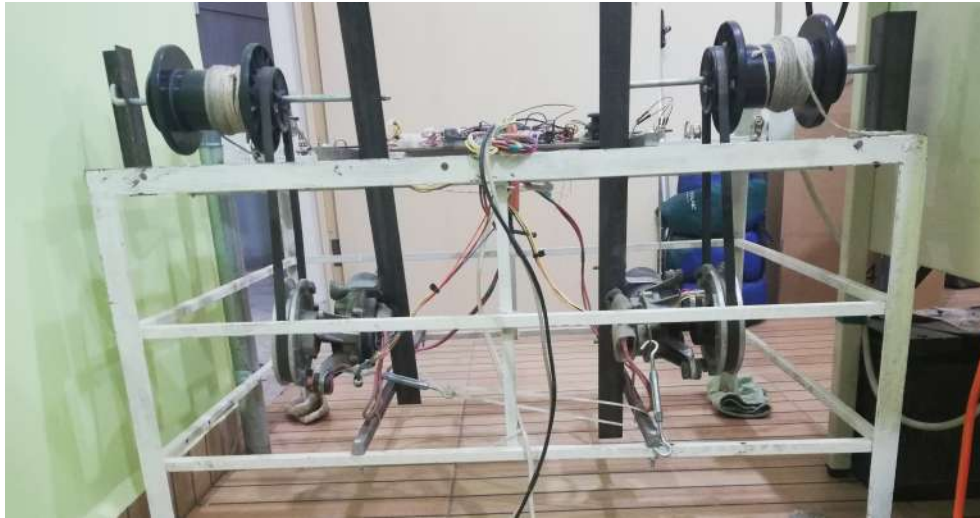
Figura 4.7: Vista de los motores, los carretes, las poleas y las bandas implementados en el prototipo.
