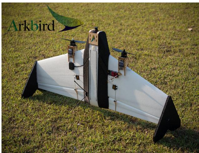
**Figura 1.1:** UAV modelo tailsitter.
