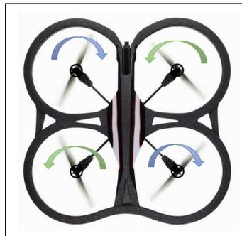
**Figura 3.2:** Configuración del cuatrirrotor AR.Drone 2.0.
