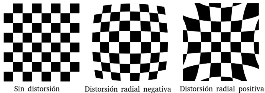
Figura 2.5: Diferentes tipos de distorsión radial.
