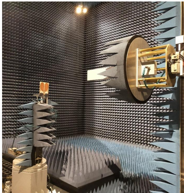
Figura 3-22 Antena montada en base rotatoria para medición
