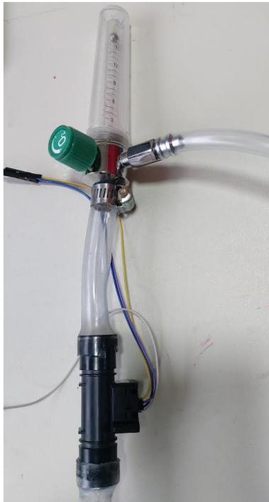
*Fig 21 Conexión de flujometro hospitalario con el sensor de flujo*
