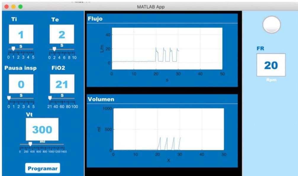
Fig 66 Intergaz gráfica de la configuración de volumen tidal
