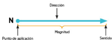
Figura 2. 5. Un vector (flecha) es la representación gráfica que representa a las fuerzas (Covarrubias et al., 2018, p.122).
