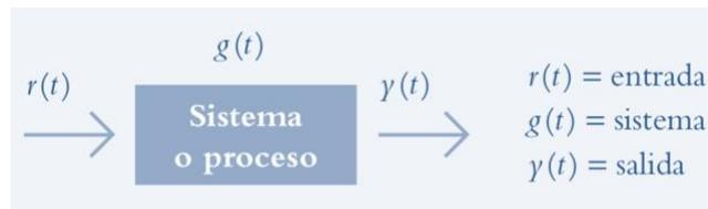
**Figura 2.6.** Relación de la entrada y salida de sistema de control
