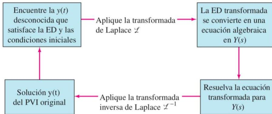
**Figura 2.5.** Procedimiento de aplicación de la Transformada de Laplace para resolver una ecuación diferencial (ED) con valor inicial (Zill y Cullen, 2006, p. 203)
