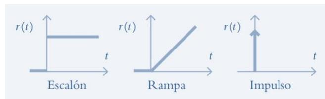
**Figura 2.7.** Algunas entradas aplicadas a los sistemas de control
