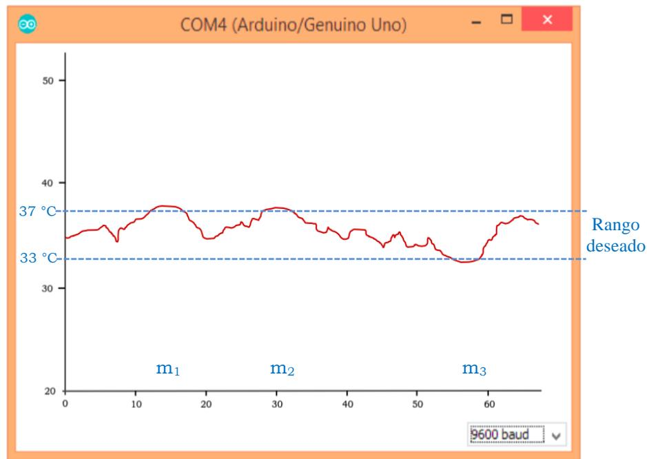
**Figura 5.5.** Comportamiento de la temperatura en la señal de salida del sistema
