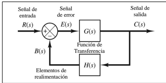
Figura 2.8. Diagrama de bloques de un sistema en lazo cerrado (Ogata, 2010)
