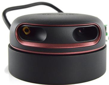
Fig. 4.7: Sensor láser rotatorio utilizado para detectar el camino durante el vuelo
