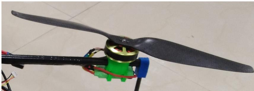
Fig. 4.3: Brazo de multi-rotor con la base impresa en PLA
