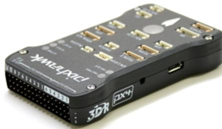
Fig. 4.5: Autopiloto Pixhawk version 1 fabricado por 3DRobotics.
