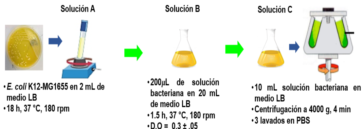
Figura 3.3. Proceso de cultivo bacteriano de E. coli . Solución A) Activación de la cepa (overnight). Solución B) Regularización del tiempo de generación de las bacterias para obtener una D. O= 0.3. Solución. C) Lavado por centrifugación de la solución bacteriana.
