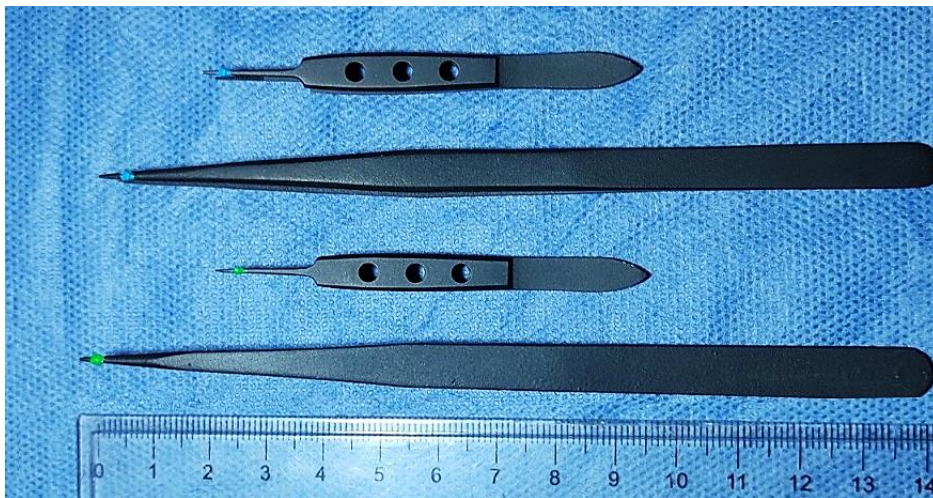
Fig. 3.10 Instrumental microquirúrgico. Las pinzas se pintaron de negro mate y se colocó un marcador de color verde o azul cerca de la punta para facilitar su rastreo.
