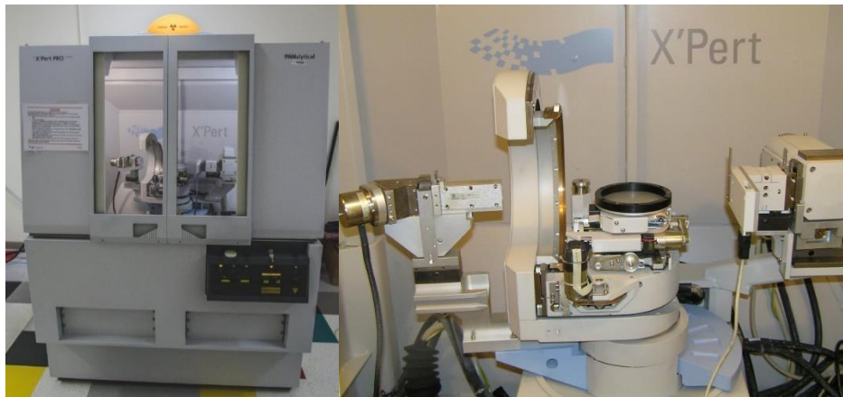
Figura 3.3. Difractómetro de rayos X marca PANalytical, modelo XPERT-PRO utilizado para la caracterización estructural de los fotocatalizadores.
