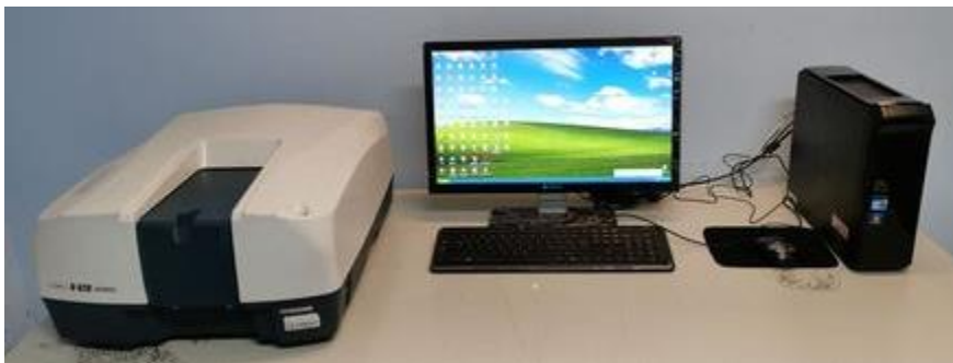
Figura 3.5. Espectrómetro marca Jasco, modelo V-670 utilizado para la caracterización óptica de los fotocatalizadores, así como la PC para observar los espectros de transmitancia y absorbancia.
