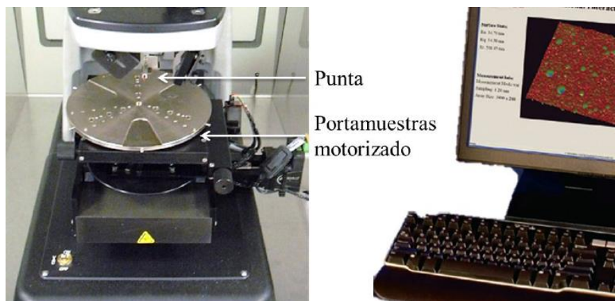
Figura 2.12. Partes básicas de un perfilómetro [2.30].
