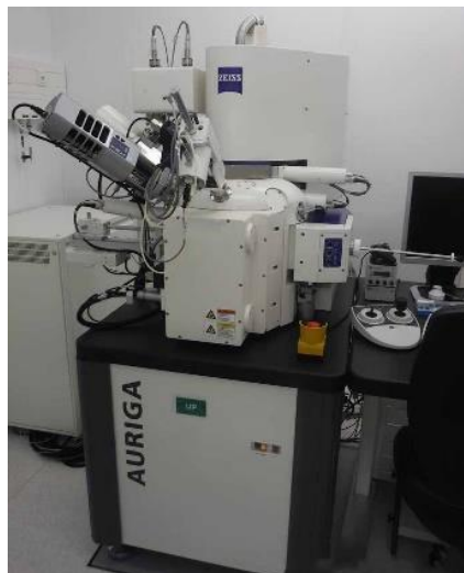
Figura 3.8. Fotografía del microscopio electrónico de barrido FE HRSEM Auriga 3916 utilizado para la caracterización morfológica de las películas delgadas de ZnO y ZnO:Cu.
