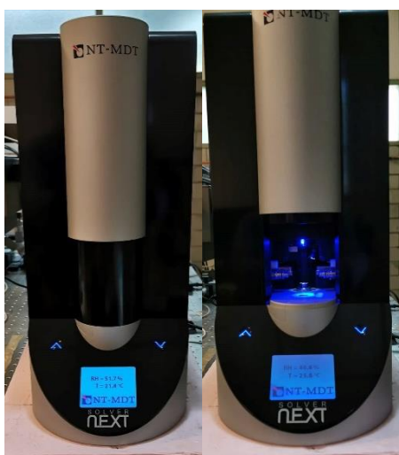
Figura 3.7. Fotografía del microscopio de fuerza atómica marca Solver next modelo NT-MDT utilizado para el análisis de rugosidad de las películas delgadas de ZnO y ZnO:Cu.
