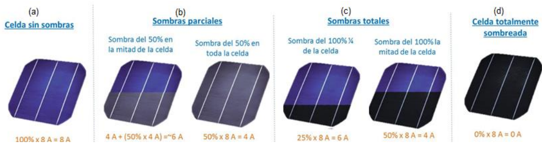
Figura 29 (a) Celdas sin sombra, (b) sombras parciales, (c) sombras totales y (d) celda totalmente sombreada.
