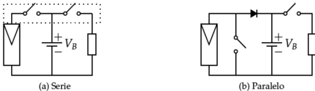
Figura 7 Esquema eléctrico de un regulador de carga (a) Serie y (b) Paralelo.
