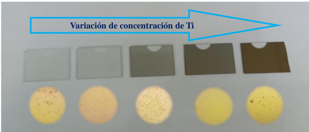
Figura 4.35 Característica superficiales de las películas de  $Ga_2O_3+Ti/GS$  nanocompuestos en función de la concentración de Ti, obtenidas por el método de co-sputtering.
