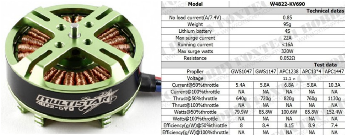
Figura 3.1: Motor brushless y especificaciones.
