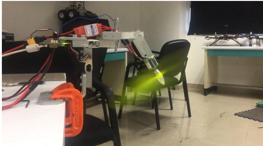
Figura 3.5: Banco de pruebas de hélice con motor en transición
