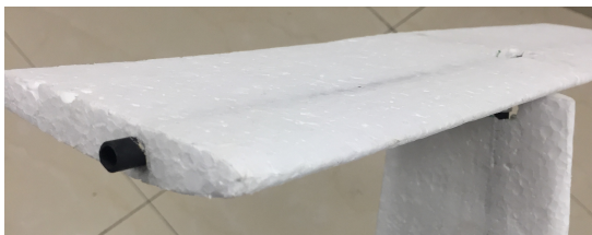
(c) Tubo de fibra de carbono como refuerzo
