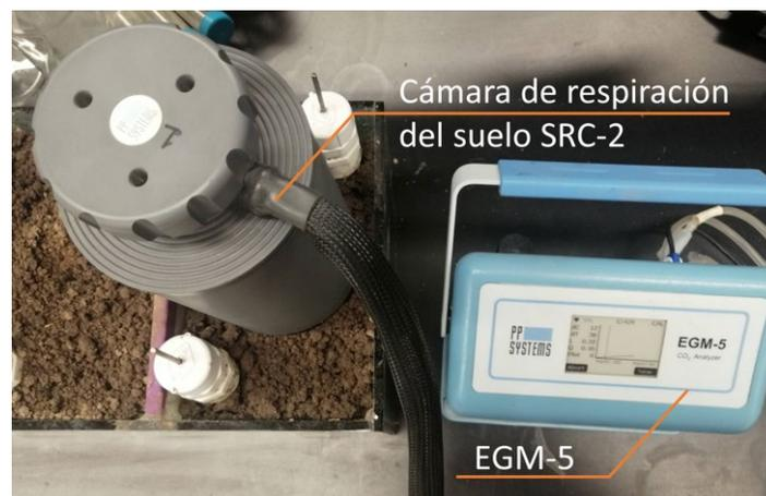
Figura 21. Registro de la respiración basal antes y después del TEQ mediante cámara de respiración SRC-2 acoplada al EGM-5.
