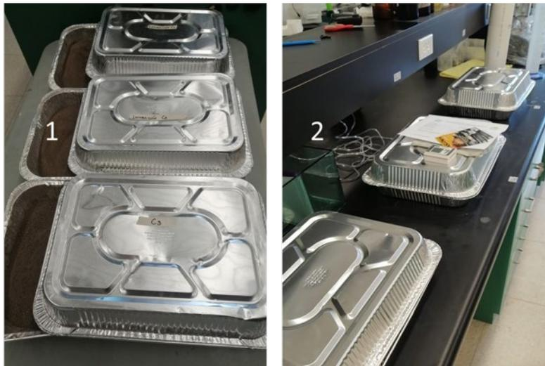
Figura 10. En (1) se muestran las charolas en donde se llevó a cabo el proceso de incubación con las distintas soluciones electrolíticas (agua y electrolito) y en (2) se aprecia la micro estación WatchDog sobre la charola central.
