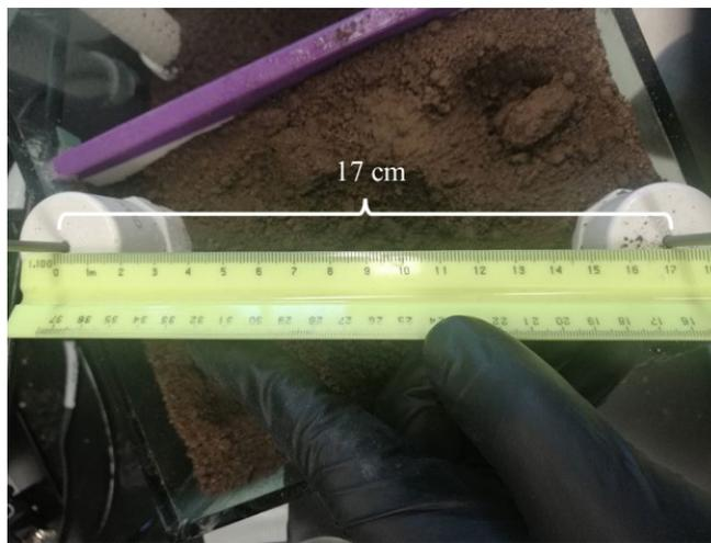
Figura 12. Colocación y distancia entre los electrodos durante el TEQ.
