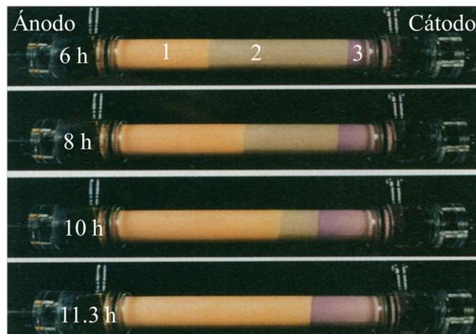
*Figura 3. Movimiento del frente ácido (1, amarillo) proveniente del ánodo y un frente básico (3, violeta) que surge del cátodo durante una prueba para la remoción de Zinc, después de 11.3 horas se genera la zona de transición, frenando el avance del frente ácido y por ende la remoción de los contaminantes. El suelo sin tratar se encuentra en la región central de la celda de tratamiento (2, marrón) [81].*
