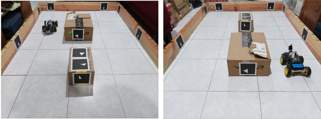
Figura 3.19: Entorno de pruebas utilizado con marcadores de tipo de orden.
