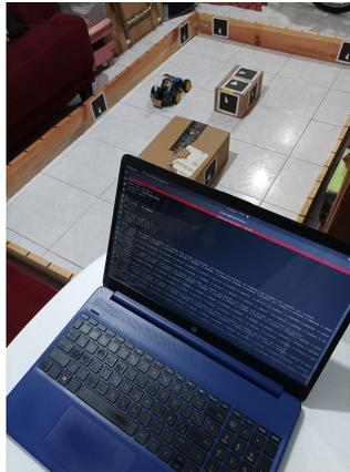
Figura 3.8: El robot en el entorno de pruebas como servidor de control y visión y la laptop utilizada como cliente.
