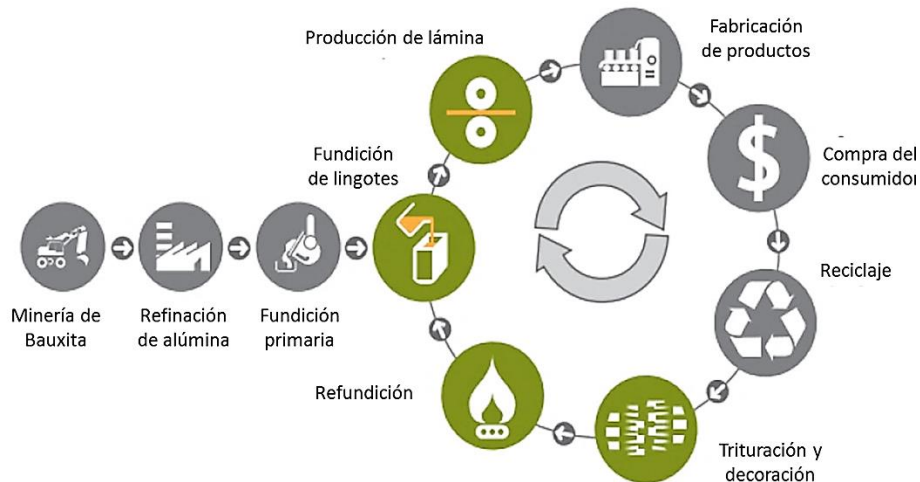
Figura 1. Ciclo de vida de una lata de aluminio. El proceso de extracción se produce en tres pasos: la extracción de la bauxita, la refinación de alúmina, y la fundición primaria. Los demás pasos se aplican tanto al aluminio extraído como al reciclado [4].
