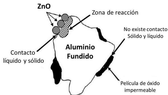
Figura 3. Diagrama del mecanismo de reducción aluminotérmica del óxido de zinc por aluminio fundido.
