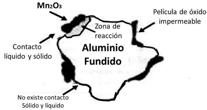
Figura 4. Diagrama del mecanismo de reducción aluminotérmica del trióxido de Mn por aluminio fundido.
