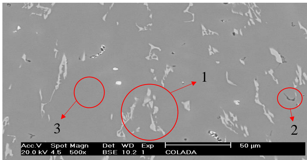
Figura 9. Microestructura tomada en MEB de la aleación Al-Zn-Mn en estado de colada. 1: \beta -Al 6 (Mn,Fe), 2: Al(FeMn)Si, 3: Al-Zn-Mg.
