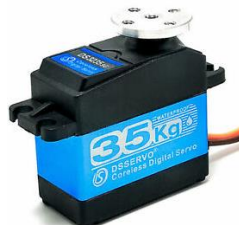
Figura 14. DSServo (DS3235) Servomotor con 35kg-cm de torque a 7.4VCD
