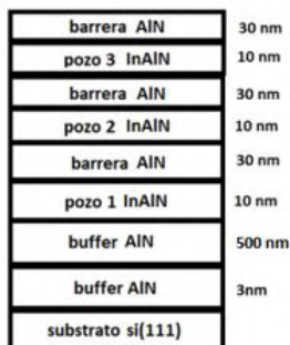
Figura 3.4: Heteroestructura de pozos cuánticos de InAlN y barreras de AlN teórica esperada por método MEE.
