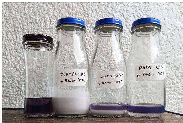
Figura 6.3: Orgánico después de 2 h del lavado con HCl. Se muestra el keroseno sin mezclar a la izquierda para comparación.
