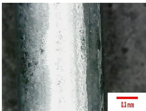
Figura 52 Recubrimiento en alambres galvanizados a concentración de fosfato 0.1M, pH 2.83, a temperatura de 40 °C.
